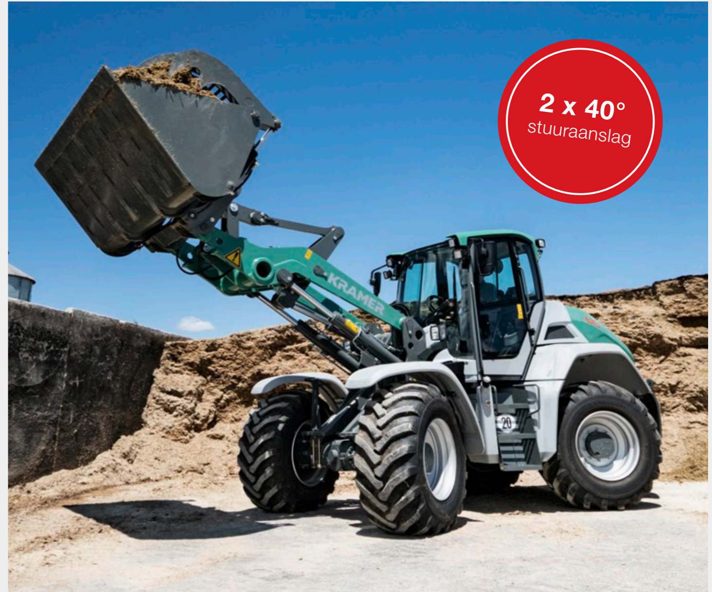
Vierwielbesturing bijzonder wendbaar bij beperkte plaats
