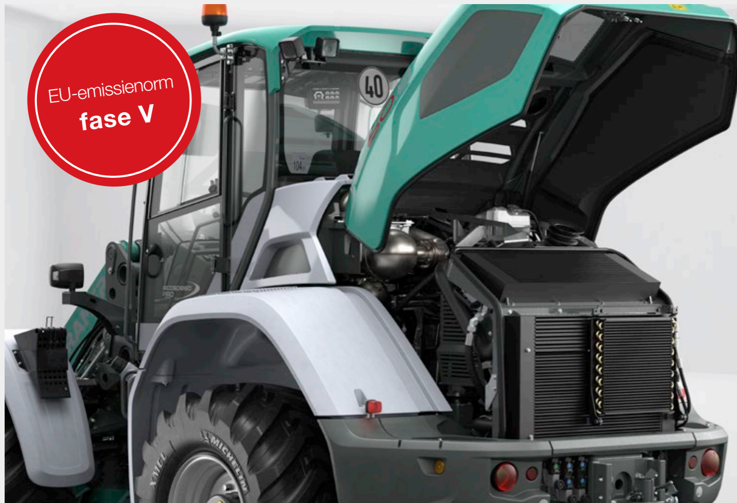
Watergekoelde 4-cilinder seriemotor met gekoelde externe uitlaatgasrecirculatie, turbolader en inlaatluchtkoeling.
